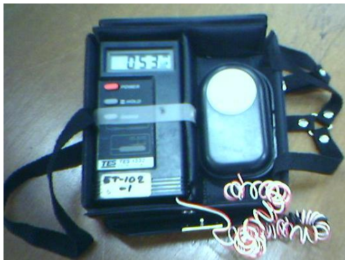
Gambar 5.10: Luxmeter , sebuah alat pengukur cahaya
